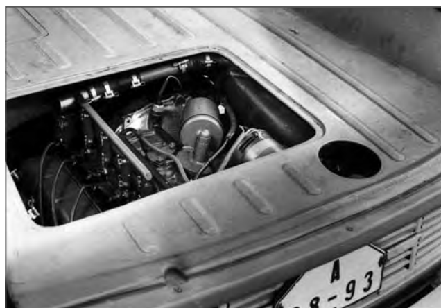
Přístup k ležatému motoru nebyl snadný
