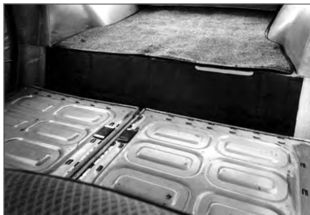
Kryt motoru tvořil schod v podlaze kombi
