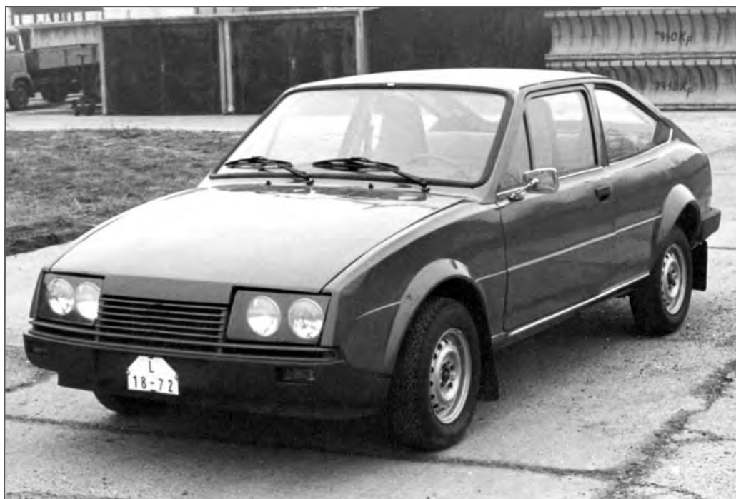
Kupé Locusta s motorem vpředu napříč a pohonem předních kol
