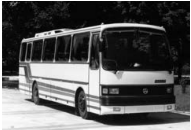
Čavdar 430 byl v licenci vyráběn západoněmecký autobus Kässbohrer Setra S 215H. Tento model nabízel 53 míst k sezení a mohl jet maximální rychlostí 125 km/h, k čemuž pomáhal vznětový pětiválec MAN D 2865 LOH-EURO 1 o výkonu 198 kW při 2000 otáčkách za minutu
