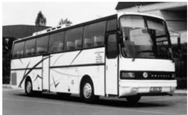
Čavdar 530 byl opět licenční zájezdový autobus Kässbohrer Setra S 215HD, který byl vybaven šestiválcem MAN D 2866 LOH-EURO 1 o výkonu 271 kW při 2000 otáčkách
