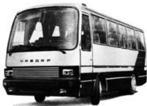
Čavdar 410 byl sedmimetrový midibus, typově podobný licenční modelové řadě 430 a 530. Tento autobus pro 30 sedících cestujících byl určen pro potřeby linkové, případně dálkové meziměstské dopravy
