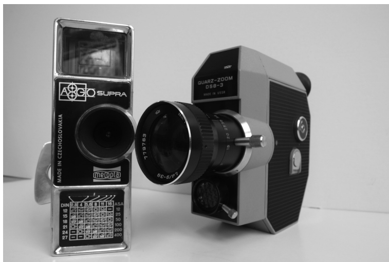
Obrázek 2: Staré, ale kdysi velice ceněné a spolehlivé kamery na 8mm film. Tuzemská kamera z Meopty neměla zabudovaný expozimetr, proto se clona určovala podle citlivosti filmu a tabulky. Kamera Quartz již měla expozimetr i transfokátor (zoom)
