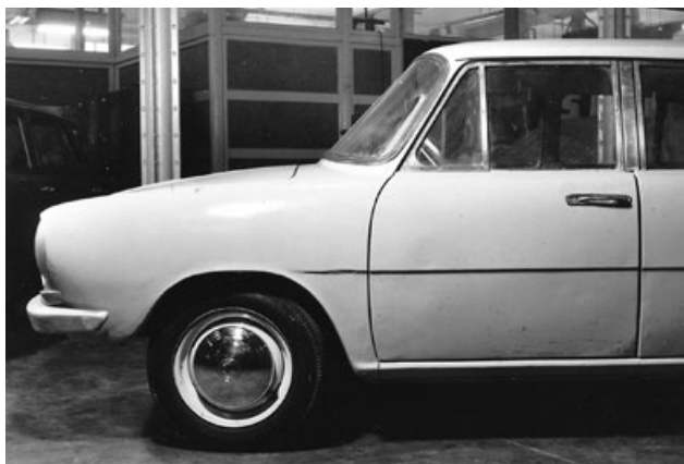
Nově tvarovaný přední blatník, zesílený střední sloupek a nové rámy oken
