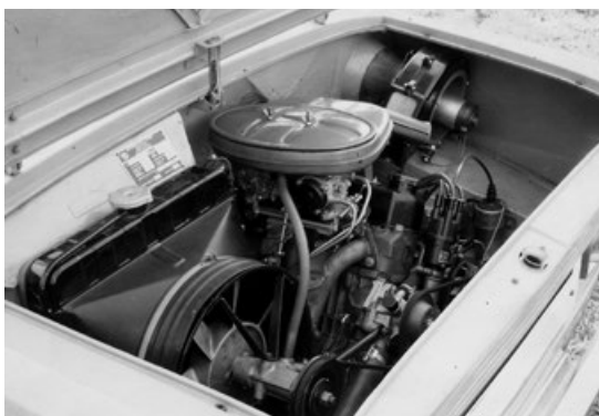
Čtyřválec 1107 cm 3 TS se dvěma karburátory dával výkon 60 k SAE (44 kW)
