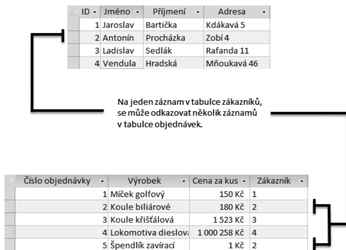
Obrázek 1.4: V relační databázi se tabulky propojují pomocí relací
